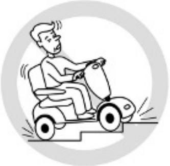
Versuchen Sie nicht, Bordsteine zu befahren, die steiler als die angegebenen Steigungen in den technischen Spezifikationen sind.
