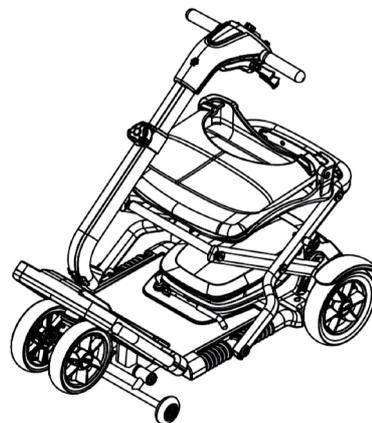
3) Verriegeln Sie das Elektromobil in der ausgeklappten Position, indem Sie den Sitz nach oben ziehen und die Lenksäule nach vorne schieben, bis ein Klickgeräusch zu hören ist. Stellen Sie sicher, dass der Einstellknopf eingerastet ist. Stecken Sie den Schlüssel ein und drehen Sie ihn, um das Elektromobil zu starten.
