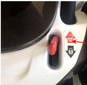
Freilaufhebel / Die maximal erforderliche Handarmkraft auf den Hebel beträgt 19 N zum Einrücken und 35 N zum Ausrücken
