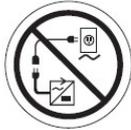
**VERBOTEN!** Verwenden Sie niemals ein Verlängerungskabel, um ihr Batterieladegerät anzuschließen. Schließen Sie das Ladegerät direkt an eine ordnungsgemäß verdrahtete Standardsteckdose an.
