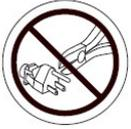
**VERBOTEN!** Das Entfernen des Erdungsstiftes kann zu Gefährdung durch elektrischen Strom führen. Falls nötig, nutzen Sie einen 3-poligen Stecker-Adapter, der ordnungsgemäß mit einer 2-polige Steckdose verbunden wurde.
