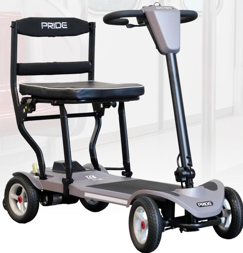
Der Go Go MG definiert Leichtigkeit neu und setzt Maßstäbe als eines der leichtesten Elektromobile der Welt, dank seines fortschrittlichen Magnesiumrahmens.
